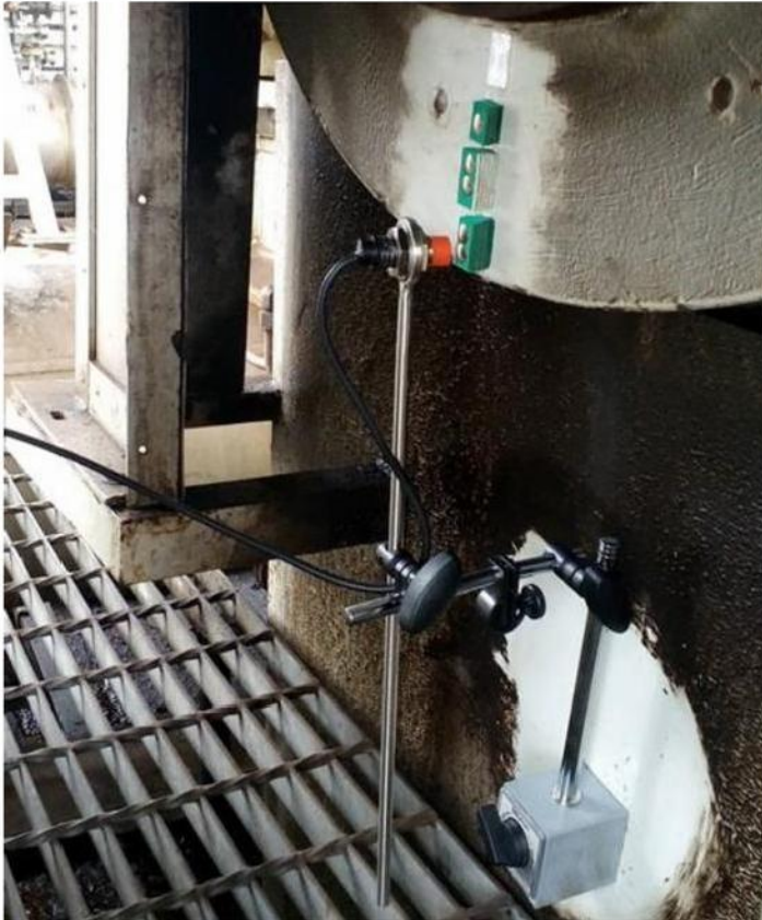
Gambar 80 Penanda kecepatan putar, sensor RPM (magnetic pickup) & lengan penyangga.
