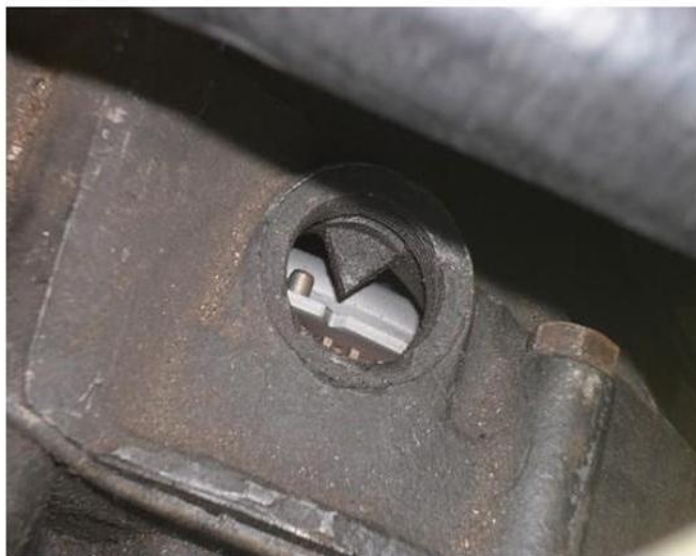
Gambar 78 Contoh penanda TDC pada flywheel
